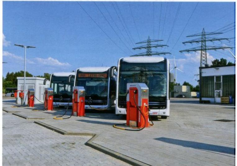
Bild 2: Ein intelligentes Lademanagementsystem sorgt dafür, dass alle Fahrzeuge bedarfsgerecht, kostengünstig und batterie-schonend geladen werden (© Stefan Tintera/INIT)
