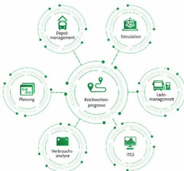
MOBILerange erzeugt ein Modell für den Energieverbrauch des jeweiligen Fahrzeugs und berechnet als zentraler Dienst die für das jeweilige Subsystem erforderliche Reichweitenprognose, z.B. für das Lademanagement-, das Depotmanagementsystem oder das ITCS (Bild: INIT).
