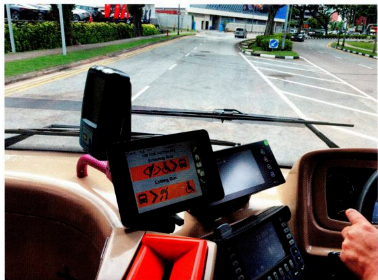
Bild 2: Der Busfahrer erhält eine Benachrichtigung, wenn Fahrgäste mit körperlichen Einschränkungen ein- oder aussteigen möchten. Hier ein Fahrercockpit während des Testprojektes in Singapur (Bild: LTA)
