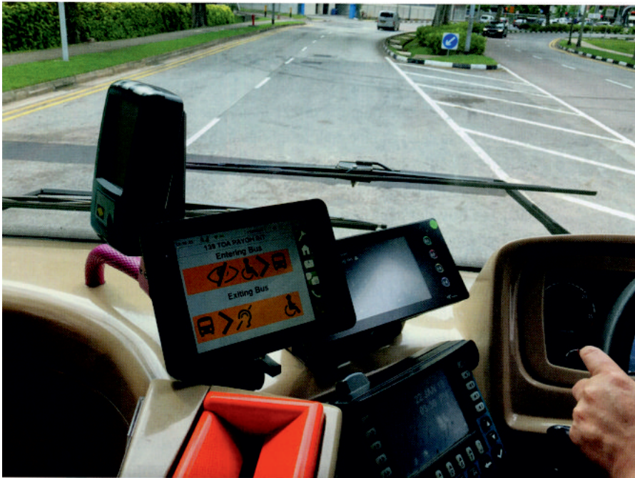
Der Busfahrer erhält eine Benachrichtigung, wenn Fahrgäste mit körperlichen Einschränkungen ein- oder aussteigen möchten. Hier das Fahrerdisplay in Singapur (Bild: LTA).
