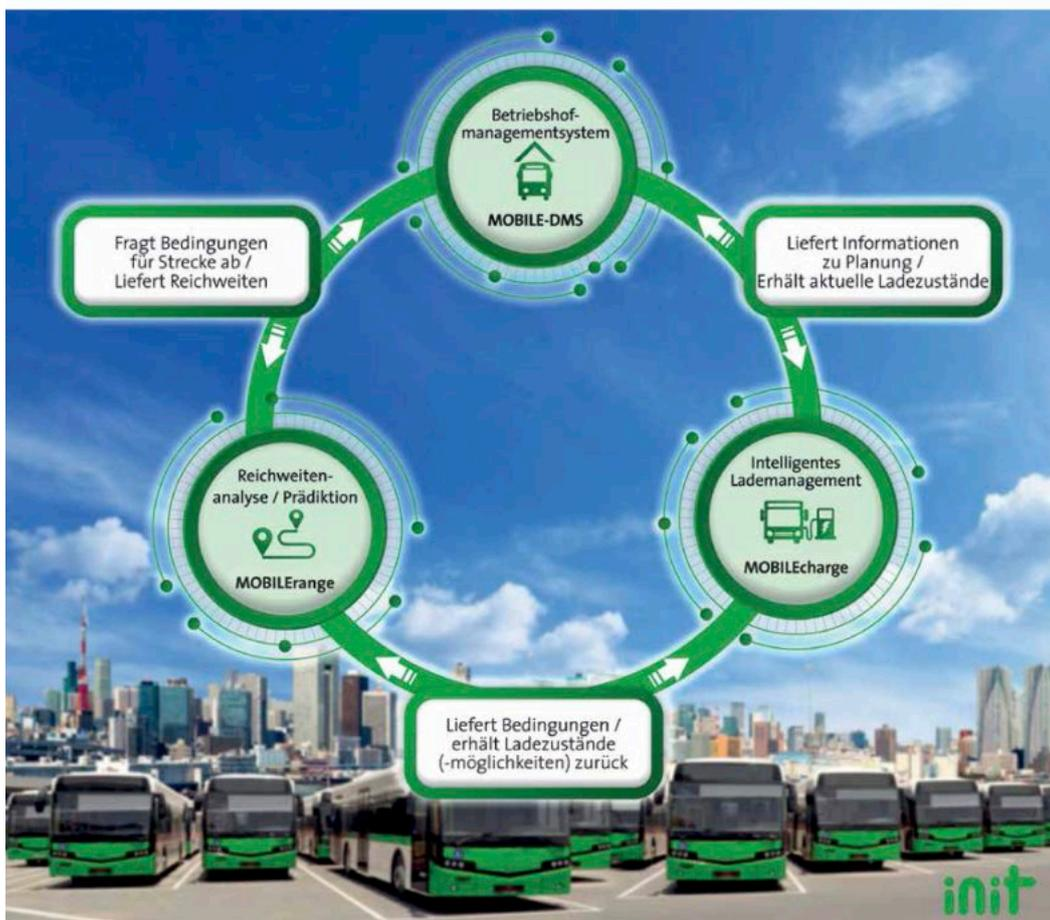
Das Betriebshofmanagementsystem MOBILE-DMS sorgt im Zusammenspiel mit MOBILEcharge und MOBILErange dafür, dass die Elektrobusse rechtzeitig geladen und vorkonditioniert für ihren Einsatz zur Verfügung stehen.
